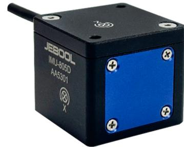
IMU-805D集成了3轴加速度和3轴角速度，以及6通道的ADM数字化模块，实现了IMU数据一体化采集，通过DDAS总线控制和数据传输。其内部包括一个高精度LDO稳压和硬件抗混叠低通滤波电路，实现了加速度和角速度信号的精密测量。IMU-805D配有高性能耐磨线缆，通过2个安装孔来固定，可以根据客户需要，来配置接头。
