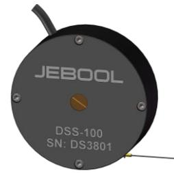
位移传感器 DSS-100，内部包含一个可调电位计，并同轴设计钢丝线圈，当钢丝拉伸或收缩时，电位计阻值随之变化，其内部独特的设计，使得位移量与输出电压保持了良好的线性关系。钢丝采用 304 不锈钢材料，及大张力设计，非常适用于高速测量应用，如汽车碰撞试验中零部件移动，以及航空机载设备状态监测。
