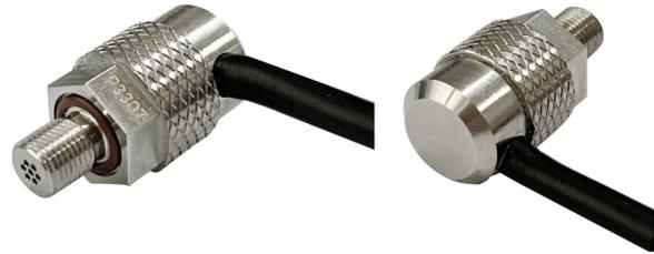
压力传感器 AP50KL 基于压阻原理，内部包含一个全桥电路，以大气压作为零点，当检测到外部气压变化时，内部桥路电阻发生变化，进而转换为电信号变化，从而实现气压测量。内部可靠精密的 MEMS 工艺，保证了输出电压信号与被测电流有较好的线性关系。AP50KL 配有高性能耐磨线缆，采用 M5×0.5 螺纹安装，端部橡胶圈密封。另外，可以根据客户需要定制不同安装螺纹。
