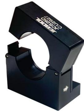
电流传感器 JCS25D 基于霍尔原理，实现对线上电流的高精度测量。独立的供电与测量系统完全隔离，直接输出电压信号与被测电流有较好的线性关系。默认量程 500A，其他量程可定制，最大 1000A。JCS25D 配有高性能耐磨线缆，线缆长度可以定制。另外，可以根据客户需要，配好 Dallas ID 和接头。
