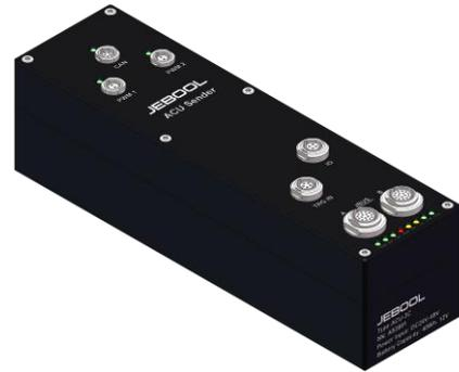
ACU 发送器 ACU-3C 主要应用于台车或整车碰撞试验中，模拟 ACU 对基于 CAN 总线和 PWM 协议的部件（如安全带总成）进行功能验证，进而快速对车辆进行开发。CAN 报文和 PWM 的发送，可基于 ARM, T0, 数字量输入等标记，进行单次或循环报文发送。提供命令编辑软件，试验时可脱机自动执行。设备内置了锂电池并具有 UPS 功能。并采用了 JBUS 总线结构，方便与其他设备连接和功能扩展。
