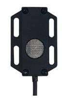
氦气传感器基于气体导热原理,实现空气中氦气浓度的检测。其内部使用的气体导热传感器,采用 MEMS 加工技术,利于被测组份和参考气体的导热响应。传感器内部运用运放反馈和偏置电路,不仅防止 了温漂且使得最终输出线性模拟信号。同时,传感器内部可集成 MCU 及 485 总线模块,可选总线输出传感器信号。传感器配有高性能耐磨线缆,长度可以定制。可选配 Dallas ID 和接头。
